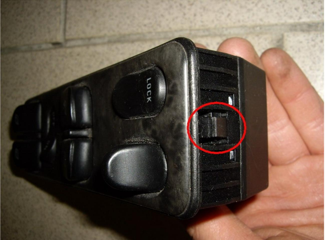
Отщелкнув зажим, вынимаем блок из посадочного места и скидываем разъем.
