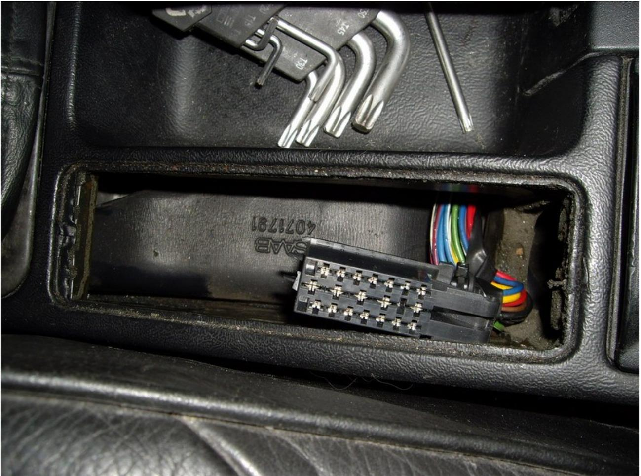
Далее разбираем блок: сначала скидываем нижнюю крышку блока, поддевая тоненькой отверткой или ножиком, постепенно освобождаем зажимы и скидываем крышку.
