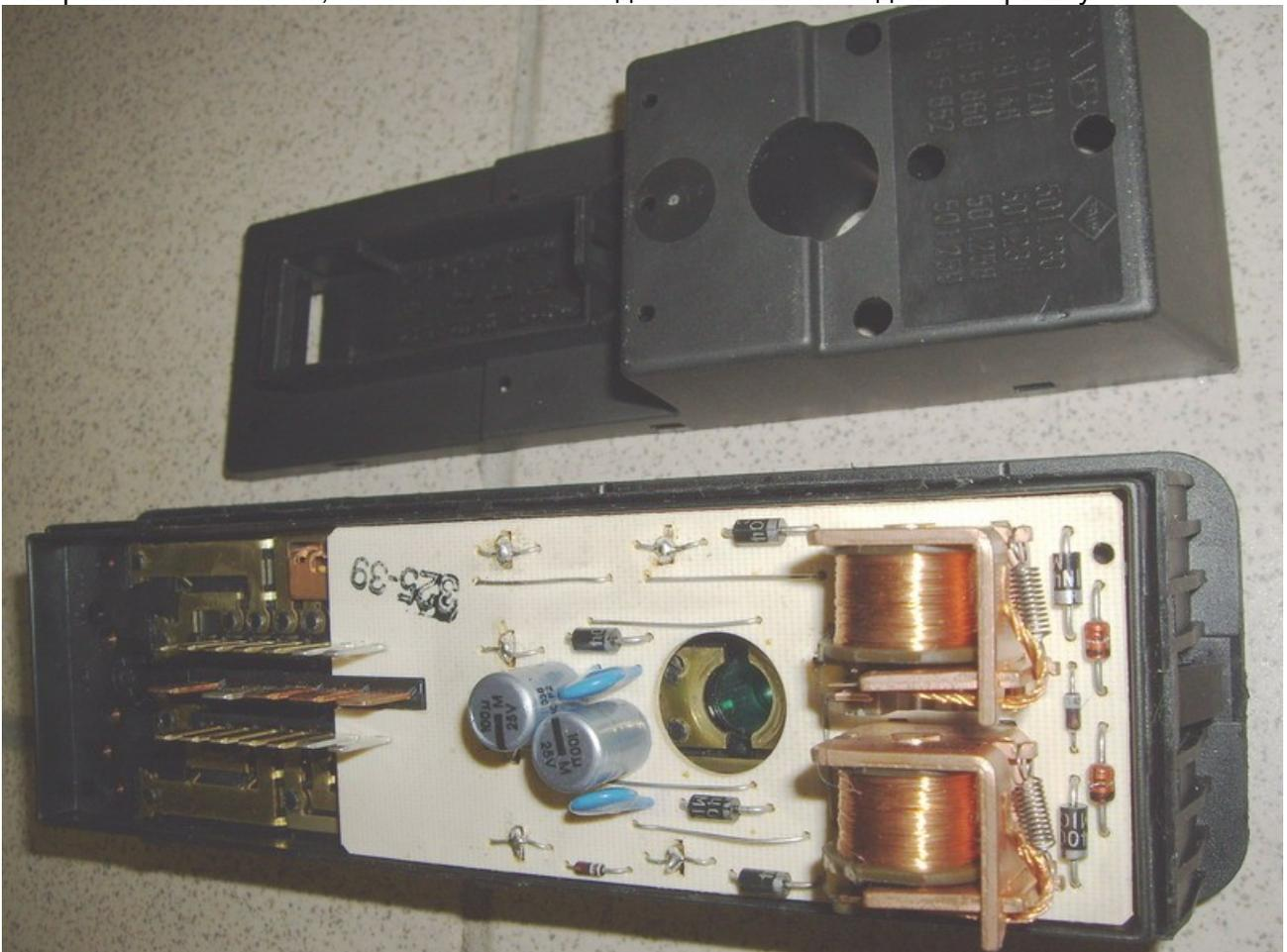
Затем проделывая такие же манипуляции отщелкиваем крышку с кнопками, но не торопимся снимать, т.к. там много мелких деталек, которые очень легко теряются. Вообще отщелкнув все зажимы, держим блок кнопками вверх и очень медленно и аккуратно снимаем панель с кнопками. Получицца что то вроде этого
